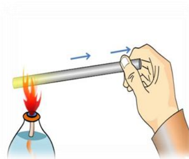
Gambar 2. 3 Contoh Perpindahan Kalor Konduksi
